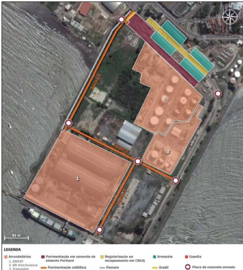
Figura 2 – Projeção de pavimentação de via, Plano Mestre Elaboração LabTrans/UFSC (2019).
